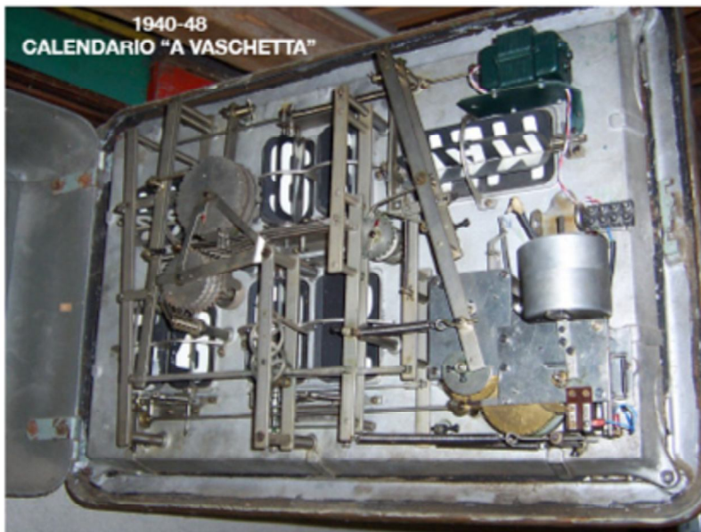
Nel periodo 1940-48 realizza il primo orologio calendario perpetuo , che si aggiorna automaticamente tenendo conto degli anni bisestili, indica ore, minuti, e data con giorno della settimana e mese.
